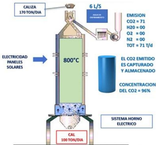
**Figura 5.** Proceso HEVA de producción de cal (Fuente: C. Villachica 2025).
